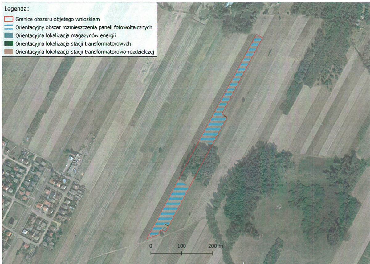
Ryc. nr 14 Orientacyjne rozmieszczenie elementów farmy fotowoltaicznej, ostateczne rozmieszczenie elementów zostanie zaplanowane w ramach projektu budowlanego. (Na podstawie Ortofotomapa GUGiK)
