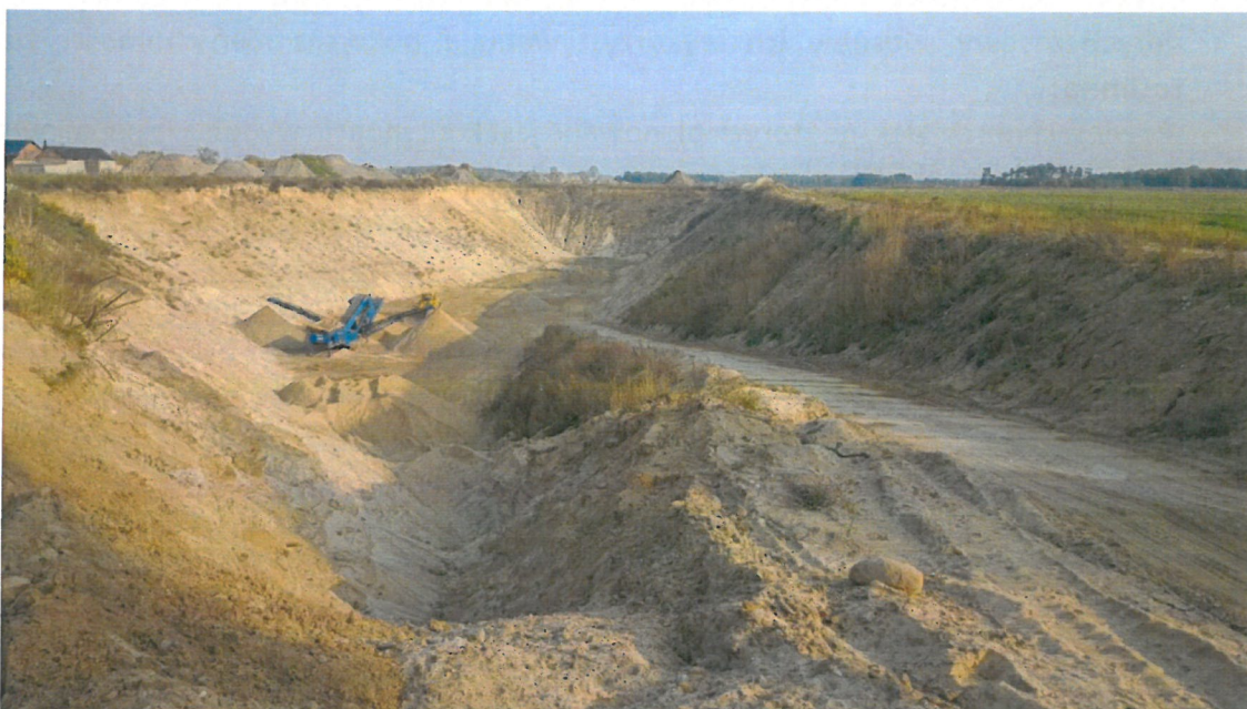
Fig. 1 Wyrobisko złoża „Barcik VII”. Widok od strony południowej. Na pierwszym planie zjazd na poziom eksploatacyjny
