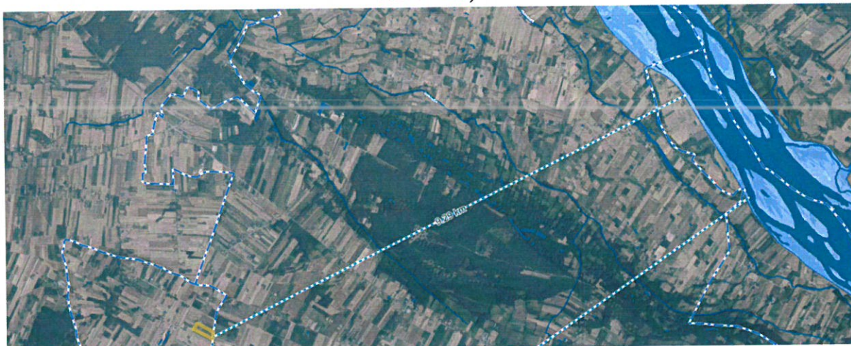
Rysunek 12. Zasięg zalewu wodą Q_p=10\% (tj. prawdopodobieństwo wystąpienia powodzi jest wysokie i wynosi raz na 10 lat)
